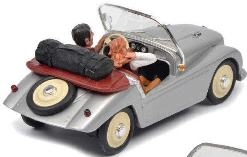
Wie unser Schuco-Modell im Maßstab 1:18 beweist, war der Kleinschnittger F125 ein vollwertiges Cabriolet für zwei erwachsene Personen. Mit einer Karosserie aus Aluminium ausgestattet, erreichte der zwischen 1950 und 1957 in knapp 3000 Exemplaren gebaute Kleinschnittger eine Höchstgeschwindigkeit von immerhin 70 km/h. Sein äußerst geringes Gewicht von lediglich 150 Kilogramm erlaubte ihm einen Benzinverbrauch von unter 3 Liter pro 100 Kilometer.
